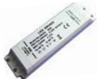
DriverLED-12V-50W-PR Driver de 50W para proyecto (plástico) Voltaje de entrada: 100-240 V~ Voltaje de salida: 12 V= Corriente de salida máx: 4.17 A Potencia máxima: 50 W Dimensiones: 170 x 46 x 40 mm
