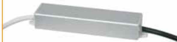
DriverLED-12V-36W-IP66 Driver de 36W para proyecto IP66 Voltaje de entrada: 100-277 V~ Voltaje de salida: 12 V= Corriente de salida máx: 3 A Potencia máxima: 36 W Dimensiones: 134 x 61 x 32 mm
