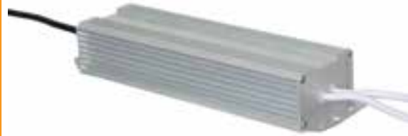
DriverLED-12V-100W-IP66 Driver de 100W para proyecto IP66 Voltaje de entrada: 100-277 V~ Voltaje de salida: 12 V= Corriente de salida máx: 8.5 A Potencia máxima: 100 W Dimensiones: 210x 72 x 45 mm
