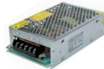
DriverLED12V-100W-PR Driver de 100W para proyecto (aluminio) Voltaje de entrada: 100-130 V~ / 200-277 V~ Voltaje de salida: 12 V= Corriente de salida máx: 8.5 A Potencia máxima: 100 W Dimensiones: 158 x 98 x 42 mm NOTA: Con Switch seleccionador de voltaje
