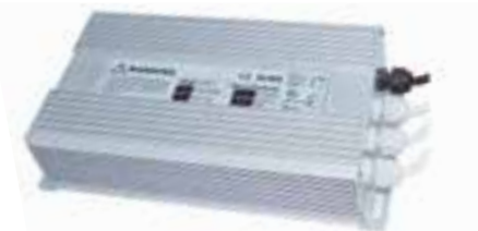
Driver-LED-12V-200W-IP66 Driver de 200W para proyecto IP66 *Voltaje de entrada: 100-240 V~ Voltaje de salida: 12 V= Corriente de salida máx: 16.5 A Potencia máxima: 200 W Dimensiones: 235 x 126 x 57 mm
