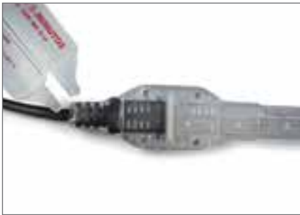
PASO5 Aplicar sellador y/o silicon en frío en ambos extremos de la conexión para evitar el paso de agua o humedad (se recomienda marca DEVCON®)
