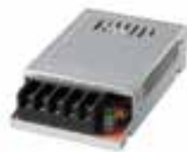
DriverLED-12V-15W-PR Driver de 15W para proyecto (aluminio) Voltaje de entrada: 100-277 V~ Voltaje de salida: 12 V= Corriente de salida máx: 1.25 A Potencia máxima: 15 W Dimensiones: 71 x 40 x 30 mm
