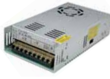
DriverLED12V-360W-PR De 360W para proyecto (aluminio) Voltaje de entrada: 100-130 V~ / 200-277 V~ Voltaje de salida: 12 V= Corriente de salida máx: 30 A Potencia máxima: 360 W Dimensiones: 200 x 110 x 50 mm NOTA: Con Switch seleccionador de voltaje
