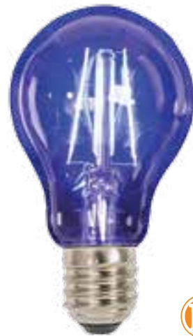
A19-LED-4.5W-FIL/AZ Bombilla tradicional de filamento LED 127V~ 4.5W Base E27 AZUL Diámetro 60mm Altura 105mm Flujo luminoso N/A
