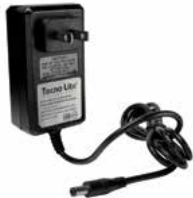
MLED-60-24W/CONTROL Driver de 24W para contacto plug-in Voltaje de entrada: 100-240 V~ Voltaje de salida: 12 V= Corriente de salida máx: 2 A Potencia máxima: 24 W Dimensiones: 80 x 52 x 45 mm
