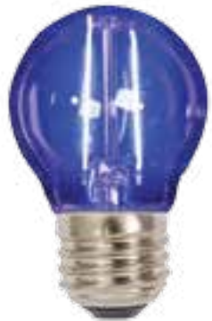
A19-LED-4.5W-FIL/AZ Bombilla tradicional de filamento LED 127V~ 4.5W Base E27 AZUL Diámetro 60mm Altura 105mm Flujo luminoso N/A
